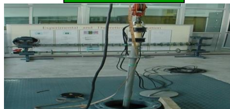
软硬地层模型井测量系统
