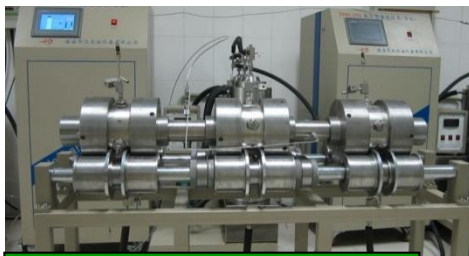
高温高压激发极化及薄膜电位测量系统
