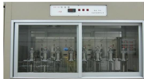
半渗透隔板岩电测量仪
